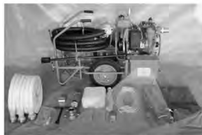
軽可搬消防ポンプ一式
