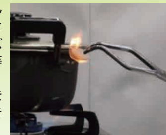
見えない炎で着火した実験映像より
