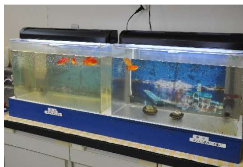
【魚類による原水監視装置】
