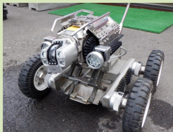
↑根室市内の下水道管を調査したテレビカメラ
