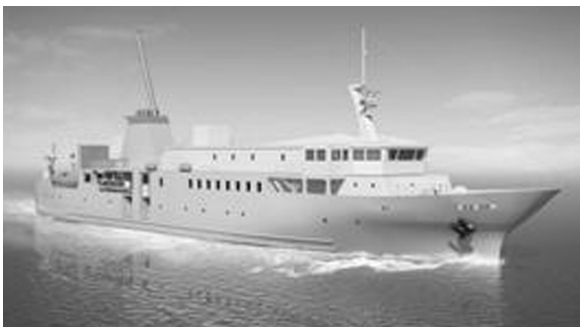
北方四島交流等事業の後継船舶「えとぴりか」 船の概要 全長約66.5m・幅約12.8m・総トン数約1,150t
